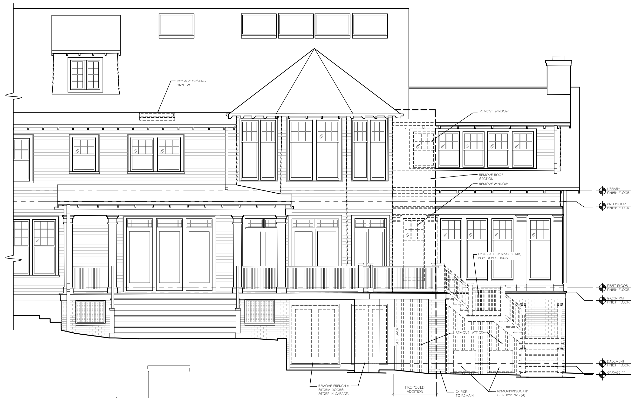
2 DEMO- EXTERIOR ELEVATION D100 SCALE: 3/16" = 1'-0" (REAR)
