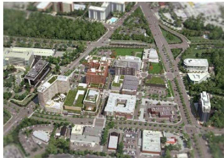
*Figura 39: En Pike y Rose, el desarrollo de rellenos redujo los flujos de escorrentía de aguas pluviales en más del 70 por ciento.*
