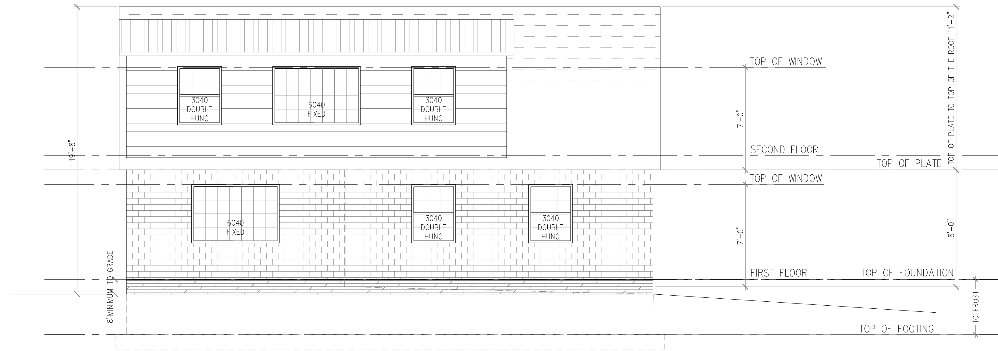
2 A003 REAR ELEVATION SCALE: 1/4" = 1'-0"
