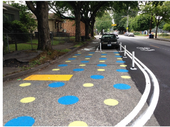
Un camino peatonal pintado en la calle está separado del tráfico por autos estacionados, bordillos temporales de concreto y postes flexibles blancos. Foto: Dongho Chang
