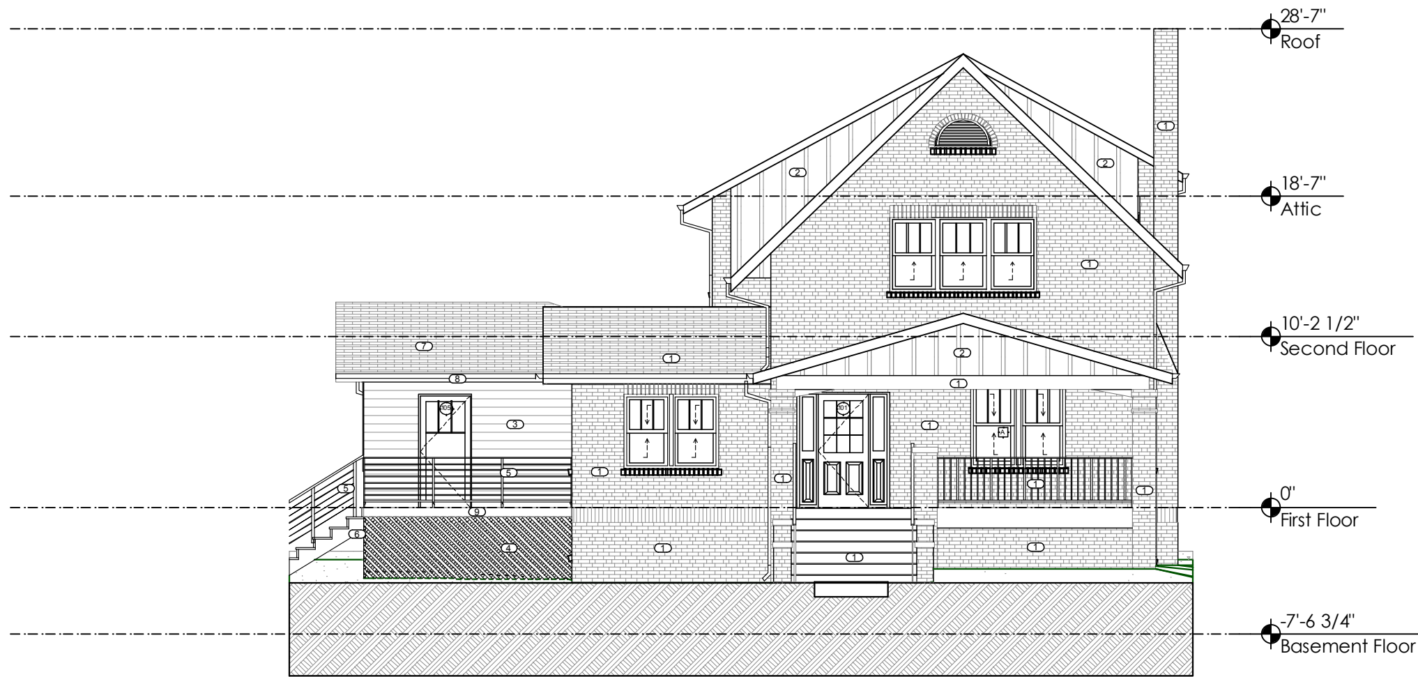
1 A9 Front Elevation SCALE: 1/8" = 1'-0"
